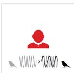
Высокочастотные звуки, которые не слышны из-за снижения слуха или мертвых зон в улитке, смещаются в зону слышимых частот. При этом учитывается пропорциональное соотношение между частотами на входе и выходе, чтобы минимизировать искажения звука.
